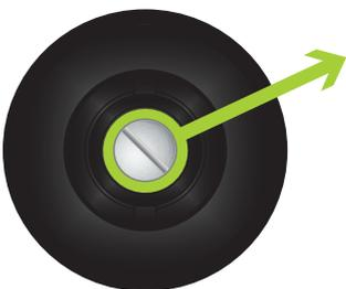
O parafuso de ajuste de pressão se encontra na parte inferior da garrafa. Com uma chave de fenda, girar sentido horário para aumentar a pressão ou no sentido anti-horário para diminuir a pressão.
